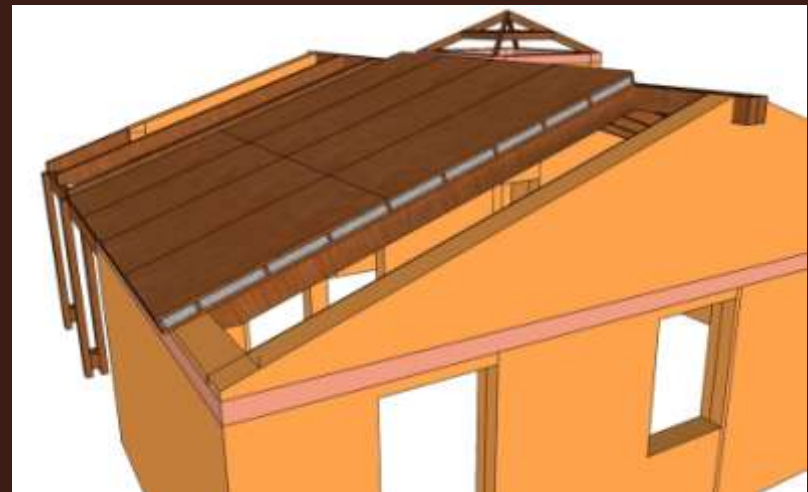
Panel sandwich para cubierta
